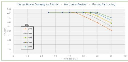
V<sub>OUT</sub>: 48, 56 V<sub>DC</sub> V<sub>IN</sub>: ≥90V<sub>AC</sub>
